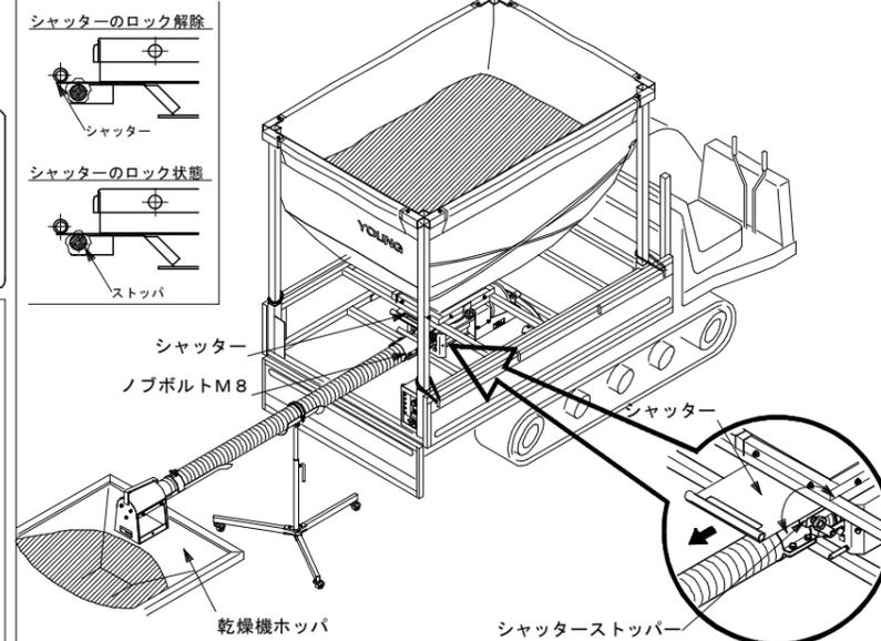
△乾燥機の張込量に合わせてシャッターで調節し、シャッターストップで固定してください。
