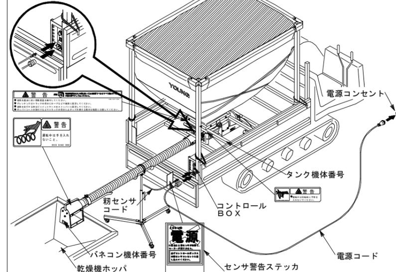
△初センサコードは100Vの電源には差さず、コントロールBOXに差し込んでください。回転方向を確認し、パネコンは外れないようにセットしてください。
