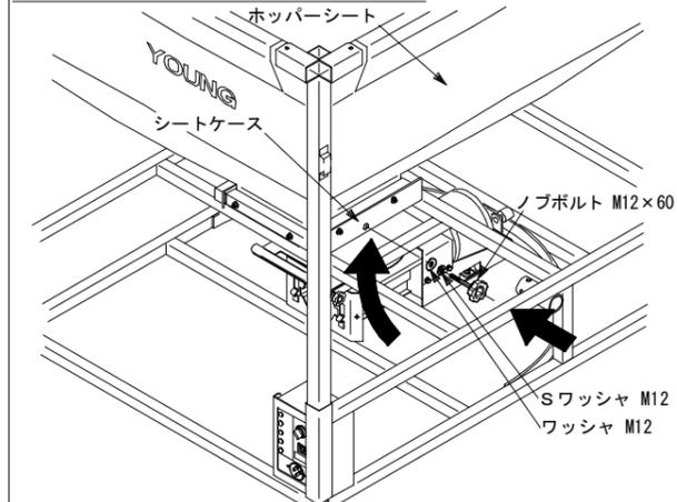
△シートケースが緩まないようにノブボルトで確実に固定してください。
