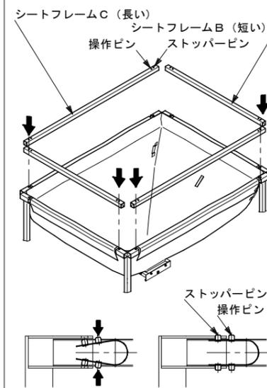
△ホッパーシートの後部分に通してから上下の操作ピンを押して、ストッパーピンをパイプ面より下げて穴にセットし、確実に固定してください。
